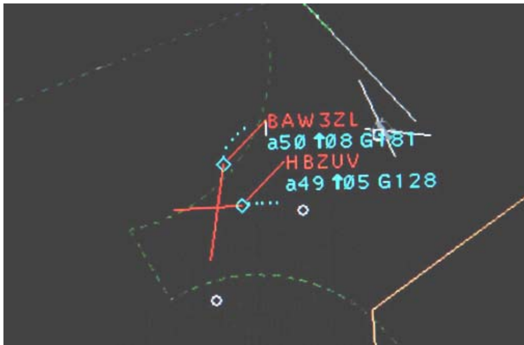
Abbildung 4: Darstellung der Situation kurz vor der nächsten Annäherung der beiden Luftfahrzeuge gemäss legal recording . Dieses Bild dient zur Illustration der STCA-Warnung, die auch in der Platzverkehrsleitstelle erfolgte. Die roten Flugplankennzeichen und die roten Bewegungsrichtungen stellen Warnhinweise des STCA dar und deuten auf einen sich anbahnenden Konflikt hin.
